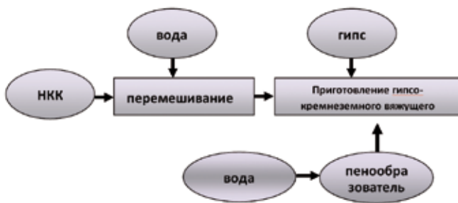
Рис. 2. Схема приготовления гипсокремнеземного пенобетона
