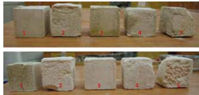
Рис. 3. Образцы после высокотемпературной обработки (1000°C): 1 – 100 % гипсовое вяжущее; 2 – гипсовое вяжущее:НВ 70:30; 3 – гипсовое вяжущее:НВ 50:50; 4 – гипсовое вяжущее:НВ 30–70; 5 – 100 % НВ
