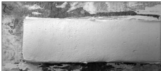
Рис. 4. Клиновой тест на трещиностойкость гипсовой шпатлевки с полиолом Sitren PSR 100
